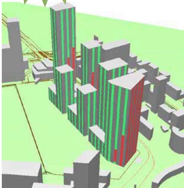
Geluidsimulatie gevelbelasting zuidwestgevels
